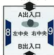
図4 出入口2方向エレベーターの設置位置について
